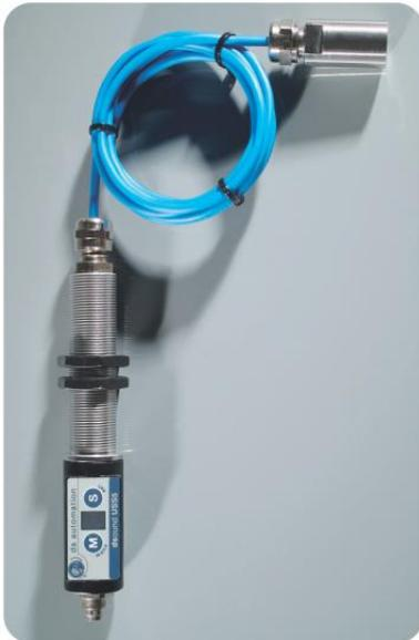
Intelligenter Körperschallsensor mit Effektivwert- und Spitzenwertregelung
